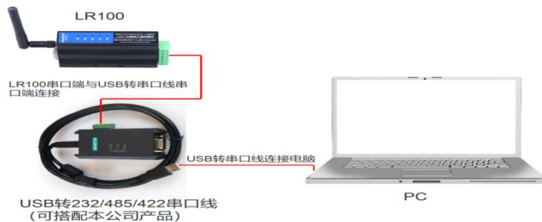
图 4.2 LR100 参数设置接线示意图
